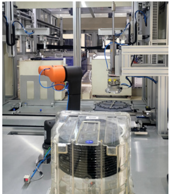
호진플라텍의 남다른 연구개발 능력은 점점 미세화되고 고집적화되는 반도체 소재 표면처리 기술의 모든 것을 아우르는 기술이다. 사진은 HBM용 u-bump 웨이퍼 도금 장비.
