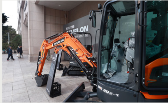
2023년 8월 HD현대인프라코어는 선행 개발을 포함해 약 40개월의 개발 기간을 거쳐 1.7톤 전기굴착기를 출시했다. 사진은 목동현대백화점 팝업스토어에서 전시된 HD현대인프라코어의 디벨론 17톤 미니 전동굴착기 DX20ZE.
