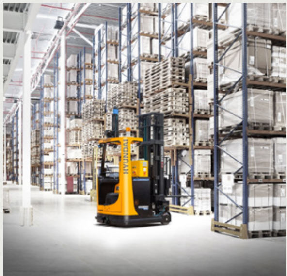
전동지게차는 1989년 미국의 예일 Yale 사와 기술제휴를 맺고 처음 생산하기 시작했다. 사진은 HD현대사이트솔루션의 적재 능력 1톤급 무인 전동지게차 RS010A-9.
