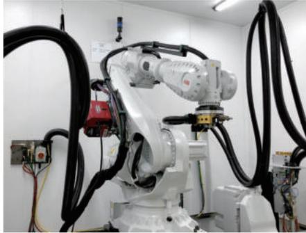
〈그림 12〉 록히드마틴의 다관절 로봇을 이용한 메탈 3D 프린팅 공정 개발
