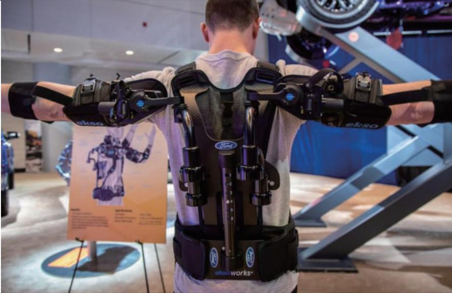
〈그림 17〉 포드 작업 현장에 적용되고 있는 Ekso Bionics 웨어러블 로봇 제품
