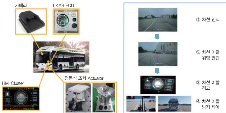
따라서 기존 유압식 조향 시스템에서 발생시키는 조향 보조력에 전동식 조향 시스템에서 발생시키는 비교적 소량의 조향 보조력이 추가되는 구조다. LKAS 동작 상황이 아닌 일상적인 운전 상황에서 조향 조작력 감소와 조향 성능 향상을 위해 MDPS ECU(Motor Driven Power Steering Electric Control Unit)에 조향 보조력 제어 로직을 탑재해 기능을 구현했다.
