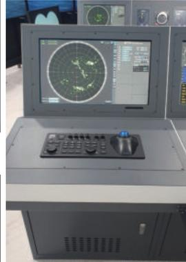
ARPA Radar 시뮬레이터 시제품 (SW 기반)
