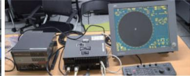
ARPA Radar 시뮬레이터 시제품 (Radar Signal Generator 기반)
