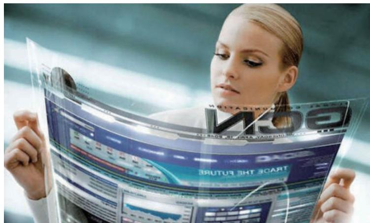
지난 2000년대 초반, 차세대 디스플레이의 선두적인 개념으로 집중적인 관심의 대상이었던 전자종이(e-Paper)는 종이에 버금가는 시인성이나 휴대성을 지녔으며, 특히 반사형 디스플레이 방식이기 때문에 백라이트가 필요 없고 LCD 패널 등 여타 디스플레이 시스템에 비해 소비전력도 극히 낮았다. 또 전원 차단 후에도 표시 내용을 유지할 수 있다는 커다란 장점으로 차세대 디스플레이의 장밋빛 전망을 10여 년 이상 이끌었다. 하지만 오늘날 전자종이 개념 중심의 차세대 디스플레이는 시장 규모가 여전히 FPD 시장의 몇 % 수준에 지나지 않으며 기계적 및 기능적 내구성, 풀컬러화, 고속응답 특성의 개선 등 혁명적 기술혁신이 여전히 요구되는 다수의 문제로 인해 아직도 가능성의 대상으로만 여겨지고 있는 것이 현실이다.
