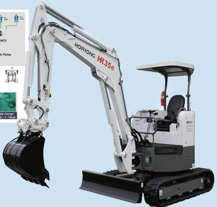
3톤급 소형 전기굴착기 개발로 국내 최초의 소형 전기굴착기 개발 기술을 확보하는 성과를 올렸다. 더불어 국내 건설기계 분야에서 최초로 DC 350V의 하이브리드(리튬이온과 슈퍼커패시터의 하이브리드 배터리 팩 기술) 배터리를 적용, 하부 주행체의 전기모터, 컴팩트한 주행감속기를 탑재해 에너지 효율의 극대화를 실현했다.
