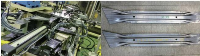
〈그림 7〉 초고강도강 차체 프레임 In-line 벤딩 성형장비 및 시제품
