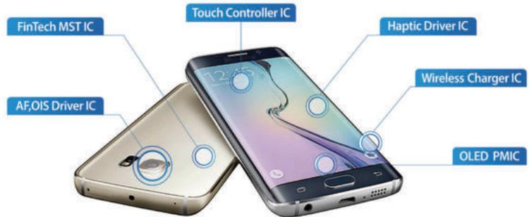
빈도수를 줄일 수 있는 초저전력 터치 기술을 개발하게 됐다. 또 모터별 최적 진동주파수를 자동으로 측정된 후 진동력을 증대시키는 햅틱 진동력 증가 기술, On/Off에 대한 빠른 반응을 구현해 물리적인 키와 같은 느낌을 내기 위한 Over Drive 및 Auto Braking 기술인 햅틱모터 제어 기술, 터치+햅틱 One-Chip 시 다른 기기의 80ms 반응속도와 달리 30ms 이내의 빠른 반응속도로 차별화된 피드백 구현이 가능한 기술 등을 갖추게 됐다”고 강조했다.
