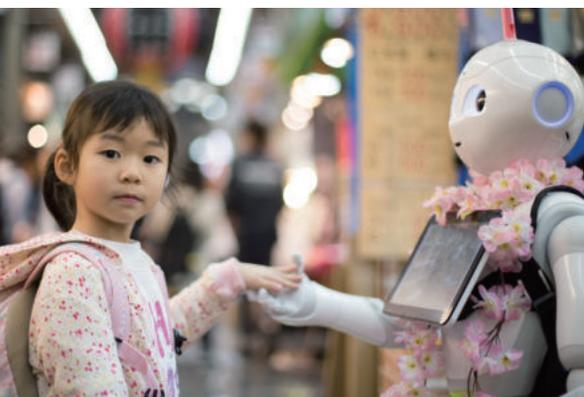
소셜로봇은 인간의 오감을 인식하는 능력, 시를 활용한 판단 및 학습 능력, 로봇의 표정과 몸을 이용한 표현 능력을 필요로 한다. 그 외에도 필요한 서비스를 상황에 맞게 효과적으로 전달하기 위한 UI, UX가 핵심 기술이다.
