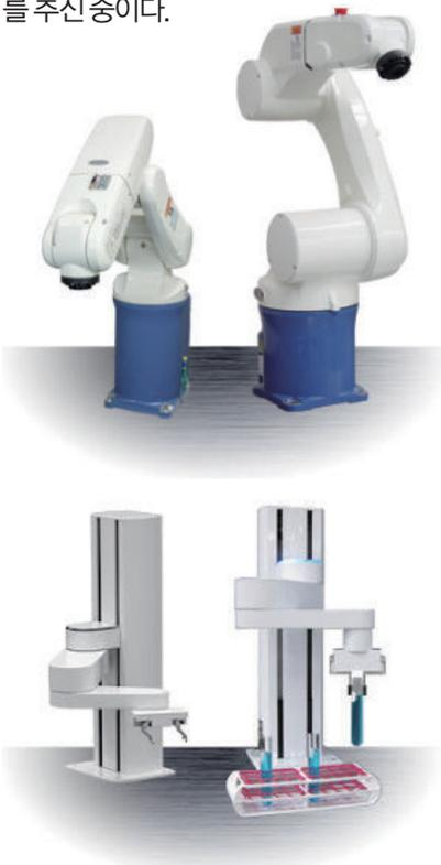
〈그림 8〉 Precise Automation의 코봇인 PAV Series(위)와 PF400/300 Sample Handlers(아래)
