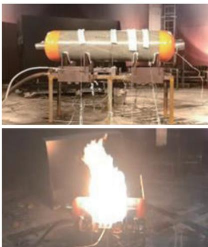
이렇듯 엄격한 성능 평가와 테스트를 통해 700bar용 장축 수소 고압용기 시험평가를 수행하고 인증을 획득했다. 개발 용기를 차량에 적용하기 위해서는 운행되는 나라에 맞는 인증 획득이 필수적이다. 인증에 따라 시험항목과 시험방법이 조금씩 상이하며 요구되는 조건도 차이점이 있다. 이에 국내 인증, 유럽 인증(EC 79) 획득을 완료하고, 글로벌 인증규격(ECE R134) 시험을 진행 중이다.
