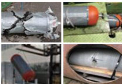
더불어 극한온도 반복시험, 가속응력 파열시험 등을 통해 저온(-40도)과 고온(85도) 등 극한의 환경에서 용기 사용 가능성을 확인했으며, 가스반복시험, 투과시험을 통한 실제 수소가스 가압·배기에 대한 내구성, 기밀성까지 검증했다.
