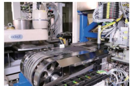
〈그림 14〉 KleVer 프로젝트: 접착장치 일체형 스트링거에서 태양전지의 전도성을 시연하는 모습
