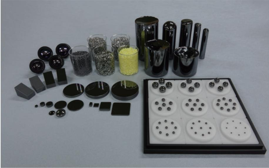
서는 적외선 광학렌즈용 소재의 요구조건을 충족하는 칼코지나이드유리 소재의 개발과 몰드 성형이 적용된 적외선 광학렌즈의 개발이 절실하다. 기존 적외선 광학렌즈는 대부분 고가의 단결정 소재를 직가공(Diamond Turning Machine)함으로써 제조단가가 높아 야간감시카메라의 민수 분야 적용에 장애요소가 되고 있다. 이러한 가운데 최근 적외선 광학렌즈의 대량생산이 용이한 몰드 성형 방법이 개발돼 저가의 몰드 성형용 적외선 광학소재가 주목받고 있다.
