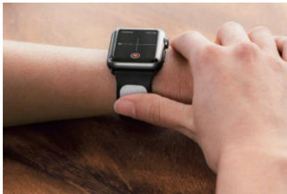
〈그림 7〉 시곗줄을 이용한 심전도 측정 기능
