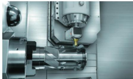
〈그림 7〉 Turn-mill CNC 가공기 기반 3D 프린팅 하이브리드 생산시스템
