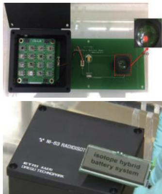
베타전지를 이용한 LED·LCD 구동 시연
