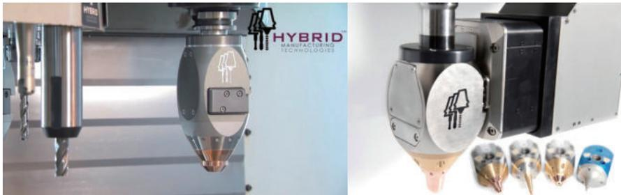
〈그림 28〉 Hybrid Manufacturing Technologies의 자동 교환이 가능한 AMBIT™ Processing Head
