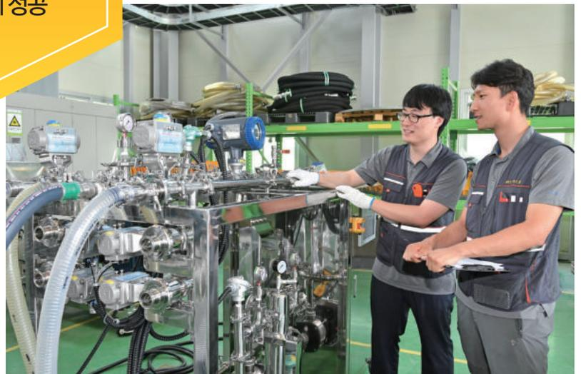
세일가스 채굴 폐수 재이용에 사용된 주력 기술은 고농도 회전와류 분리막 장치다. 농도가 더 높은 축산폐수 정화를 위해 개발된 장비라 적용에는 문제가 없었으나 이동하는 채굴 장비를 따라 이동형으로 제작해야 한다는 점, 또 경제성을 확보하고자 현지의 제반 필요 사항을 반영한 공정을 구성한 후 현장에서 성능을 실험해 보여야 한다는 점 등이 비용 문제와 더불어 가장 큰 걸림돌이었다. 다행히 산업통상자원부에서 세일가스 R&D 펀드를 만들어 이를 활용함으로써 미국의 세일가스 시장에 기술력을 선보일 수 있었다. 현재는 이를 FGD(미국 내 탈황폐수 시장)로까지 연결해 몇 개의 개별 발전사와 현장 실증 실험을 진행 중이다. 미국 환경청에서는 부강테크의 기술을 발전시켜 탈황폐수의 처리 가이드 기술로 등록을 준비 중이다. 이제 부강테크의 주력 시장은 미국이 된 것이다.
