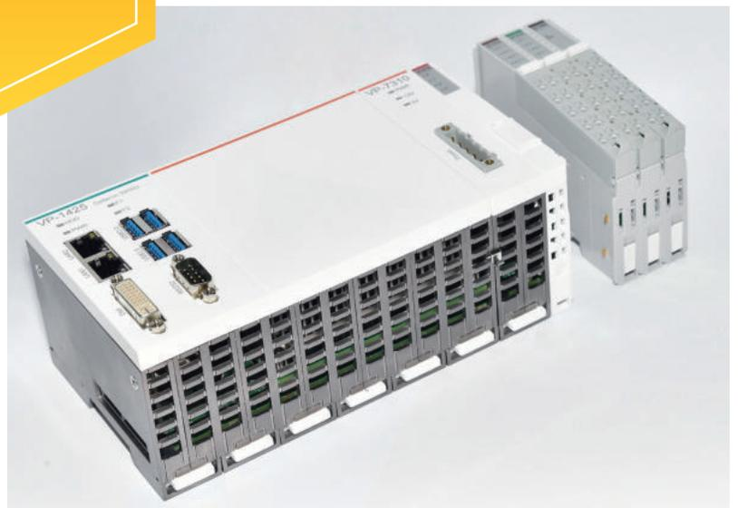
① DIN 레일에 장착 가능한 소형의 임베디드 PC : 부피가 일반 산업용 PC 대비 30분의 1이며, 산업환경에 많이 사용하는 DIN 레일을 지원하므로 쉽게 장착할 수 있다.
