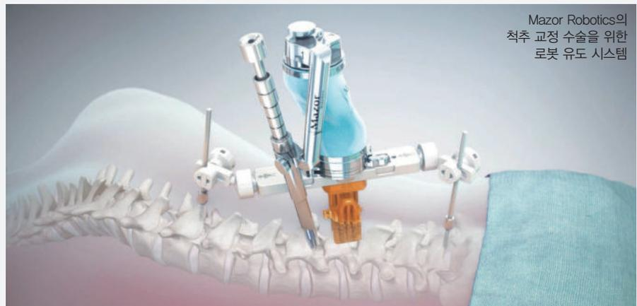
Mazor Robotics의 척추 교정 수술을 위한 로봇 유도 시스템
