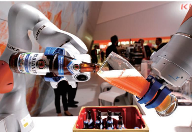
가는 방식이다. 생산라인이 IoT로 온라인에 연결돼 있어 가능한 일이다. 지멘스의 마르쿠스 라데는 “기존에는 한 라인에서 한 가지 제품만 만들어야 했지만 이 시스템을 적용하면 수십 가지 제품을 한 라인에서 생산할 수 있는 것이 장점”이라고 말했다. 세계 4위 로봇 제조업체 쿠카의 바텐더 로봇도 큰 인기를 끌었다. 바텐더 로봇은 두 개의 로봇팔로 구성돼 있다. 한 로봇이 잔을 집어 비스듬히 들어 올리면 다른 로봇이 옆에 있는 맥주병을 집어 잔에 천천히 따른다. 로봇은 맥주잔을 80% 가량 채운 다음 반듯하게 세워 마저 채우는 세심한 모습을 보여줬다. 잔을 꼭 채우면서도 맥주나 거품은 단 한 방울도 떨어뜨리지 않았다.
