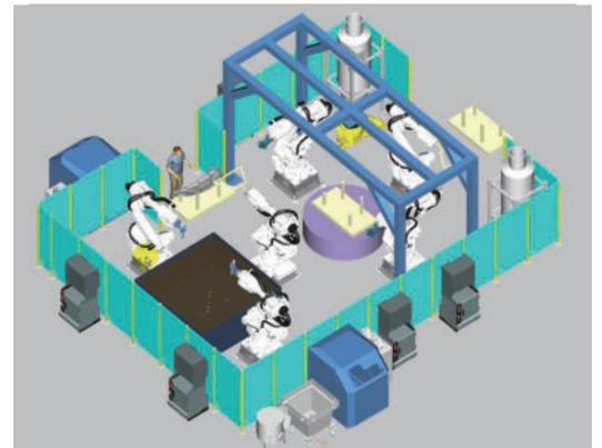
로봇 기반 탄소섬유복합재 자동차 부품 유연 가공시스템
