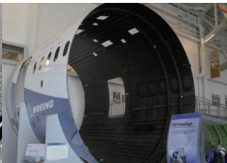
CFRP 항공기 부품(보잉787 Fuselage)
