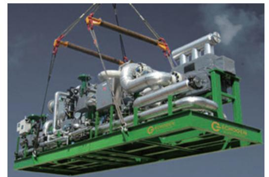
〈그림 3〉 Echogen 8MW 시스템 모듈
