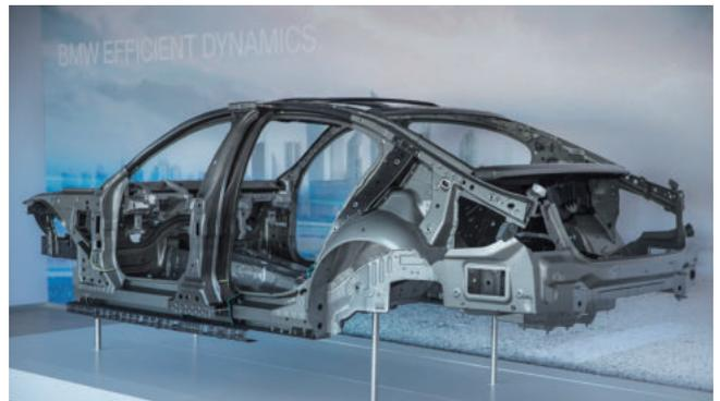
〈그림 3〉 경량 CFRP를 적용한 BMW all new 7 series
