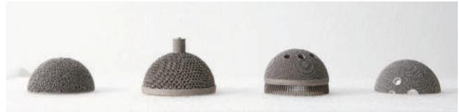
〈그림 7〉 국내 3D 프린팅 기술로 제작한 타이타늄 인공 고관절
