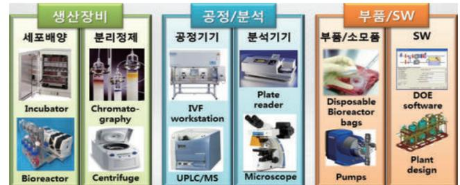
〈그림 3〉 스마트 바이오의약품 생산 시스템 구성
