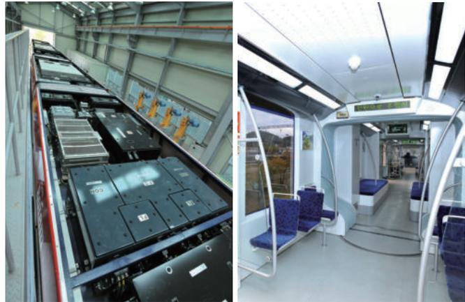
트램 상단에 설치된 2차전지(좌), 가운데 축이 없는 저상대차 기술을 엿볼 수 있는 차량 내부 모습
