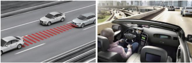
자동으로 차속 및 차간거리를 유지하는 SCC와 차선유지 지원이 가능한 LKAS는 자동차 운전보조 기술의 기반이 되는 시스템이다. 이러한 기술은 운전자의 편의, 안전을 향상을 목적으로 개발 및 적용되고 있으며 SCC와 LKAS가 통합제어되는 고속도로주행지원시스템을 시작으로 향후 궁극의 운전자 편의 및 안전을 추구하는 자율주행 기술개발로 이어질 것이다.
