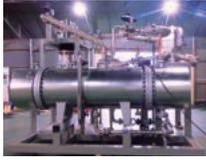
**기술내용** 저온 랭킨 사이클은 100-300℃ 수준의 중저온 열원을 이용하여 전기 및 열 생산이 가능한 시스템으로, 산업 폐열 등과 같이 활용성이 낮아 버려지는 열을 회수하여 전기를 생산, 에너지 효율을 향상시킴. 200kW급 중형 ORC 발전시스템 개발은 본 과제가 국내 최초이며, 시스템 설계기술, 핵심 부품 설계 및 제작기술, 성능 측정 및 분석기술을 독자적으로 확보함. 140℃ 열원을 이용하여 열효율 10% 이상을 달성하여 세계 최고의 기술 수준을 확보함. 200kW급 중형 ORC 발전시스템의 핵심 부품인 터보 팽창기는 높은 팽창비를 달성하기 위해 2단 레이디얼 형식으로 개발하고, 백투백 형식으로 배치하여 구조적 안전성을 확보함
