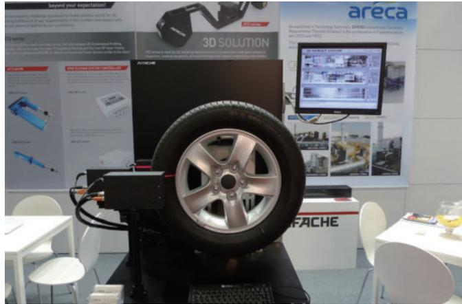
3D 이미지 센서를 이용한 타이어 Run-Out 측정 장비
