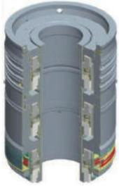
**기술내용** 원전 냉각재순환펌프의 성능시험기술의 최적화와 밀봉계통의 소내외 전원 완전상실사고(Station Blackout: SBO) 극한 조건에서의 밀봉 성능 시험평가 기술개발을 수행함. 냉각재순환펌프 성능 시험 시 고유량 조건하의 유동진동 및 외류감쇄 기구와 유동제어 기구를 개발, 성공적으로 적용하여 대형 냉각재순환펌프 고유량 시험 데이터의 신뢰성과 정확성을 제고함. 후쿠시마 원전사고 이후 강조되는 대형 자연재해에 기인한 원전 안전성 평가를 위해 요소기술이 집약된 국산 Seal 계통의 안전성을 전원 완전상실사고 극한 조건까지 확장하여 밀봉 성능을 평가함
