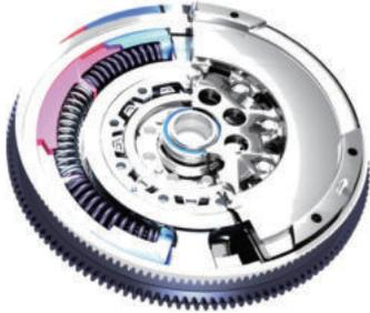
**기술내용** 차량 엔진에서 발생된 불규칙적 회전 진동을 저감시키면서 변속기로 동력을 전달하는 복합 기능성 하이브리드 플라이휠(Hybrid Flywheel, 이하 HF)은 단일 질량체(Single Mass)를 가진 기존 단일 질량체 플라이휠(Single Mass Flywheel, 이하 SMF)과는 달리 Primary Mass와 Secondary Mass의 이중 질량(Dual Mass)과, Damper Device로 구성되는 동력 전달계 소음·진동 저감을 주 기능으로 하는 신기술이며, 연비 향상을 위한 완성차 업체의 차량 엔진 고효율화와 다단 변속기의 개발 추세에 대응하는 구동계 부품 기술임
