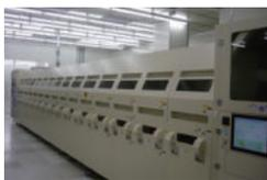
**기술내용** 본 과제는 저온 폴리 실리콘(Low Temperature Poly-Si) LCD 및 능동형 유기 EL(Active Matrix Organic Light Emitting Diode) 디스플레이에 사용되는 4세대급 (730×920mm) Poly-Si TFT 기판을 제조하기 위한 급속 열처리 장비 개발임. 4세대급 유리 기판에서 결정화 및 기타 열처리를 효율적으로 수행하기 위한 핵심 기술은 PM(Process Module) 개발, In-line Furnace 개발, 운송기구 개발, In-line Module Process 개발 등이 있음
