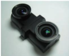
**기술내용** 지능형 로봇에서 다양한 로봇 비전(Robot Vision) 인식 알고리즘을 사용할 경우 상대적으로 고가 컴퓨터를 활용해야 하는 기존 기술은 부품 비용 한계로 저가형 청소·경비 로봇 시장에서 상용화가 어려움. 본 연구과제를 통해 이를 극복하고 저가 프로세서를 활용하여 비전알고리즘 처리가 가능한 Stand-Alone 방식의 청소 로봇용 비전인식 모듈을 개발하여 소형 청소로봇에 적용함. 천장의 특징점뿐 아니라 벽면 등에 존재하는 다양한 특징점을 효과적으로 활용하여 빠른 시간에 주위 환경 지도를 실시간 작성하며 동시에 자신의 위치를 인식하는
