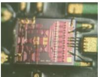
**기술내용** 휴대폰의 많은 부품이 국내 기술로 상용화됨. 국내 회로 기술과 공정 기술로 휴대폰의 핵심인 애플리케이션 프로세스, 모뎀, PMIC 등 핵심부품이 개발, 양산 중임. 휴대폰의 핵심 기능이면서, 큰 비중을 차지하는 전력 증폭기를 포함한 RF Front End Module은 거의 100% 일본과 미국, 유럽 등에서 수입에 의존하여 관련 기술개발과 인력양성이 매우 필요함. 본 연구과제를 통해 2G 휴대폰용 RF 모듈뿐 아니라 LTE 관련 기술을 확보하고, 화합물 HBT뿐 아니라 CMOS Power Amplifier 기술 및 LTE Tx, Rx 모듈로 사용하는 모듈 기술을 확보함. 핵심 기술은 EGSM900용 전력 증폭기 및 DCS1800용 전력 증폭기 개발, Tx Module Control 기술 개발, TX Module Merge 기술 연구, CMOS LTE PAM 기술 개발, LTE Tx 및 Rx 모듈 개발임
