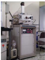
**기술내용** 계장화 압입시험은 수백 마이크로 크기의 탐침을 금속 시험편의 표면에 준비하여 파괴적으로 침투시키면서 얻어지는 기계적 정보를 분석하여 금속부재의 강도, 잔류응력, 파괴인성 등 다양한 역학 물성을 얻는 기술임. 특히 운용 중인 발전, 정유, 석유화학, 제철 관련 현장 설비에 계장화 압입시스템을 고정, 측정함으로써 장기 운용에 따른 설비부재의 열화 정보를 파악하고, 실시간 설비의 안전성을 모니터링 가능한 기술임. 이상의 보유 기술을 바탕으로 실제 설비가 운용되는 고온 환경이나 가스 분위기를 형성한 상태에서 계장화 압입시험을 진행하는 기술을 연구개발했고, 고온 및 분위기 제어가 가능한 챔버가 부착된 새로운 형태의 시스템을 개발함
