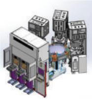
**기술내용** 매엽식(Single Wafer Type) 저압화학 열 기상 증착 장비를 이용하여 양산 라인에 적용하는 기반기술 사양을 만족하는 장비 및 공정을 개발함. 3가 원소의 불순물인 붕소(Boron)를 실리콘 증착과 동시에 첨가하여 전기 전도성을 조절하여 반도체 소자의 전극으로 사용 가능함. 기존 종횡로 형태(Furnace Batch Type)에 비해 열 노출 시간을 단축하여 차별화된 장비 및 공정 기술을 개발함. 반도체 소자의 수율 증가를 위해 발열 히터의 열 제어기술 개발로 박막 내 두께 균일도를 향상했으며 단위 공정을 개발하여 실리콘 박막의 표면 거칠기를 개선함
