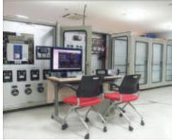
**기술내용** 태양광, 풍력, 연료전지 및 열병합 등의 신재생에너지 전원이 연계된 수용가설비 계통은 기존 부하만이 존재하는 설비 계통과 달리 소규모로서 소비자 근방에 분산 배치가 가능한 기존 부하와 혼재되어 운용되는 형태이기 때문에 신재생에너지 전원의 연계에 따라 사고 전류 증가, 양방향 보호협조 등 많은 문제점이 발생하므로 이에 대한 실계통 규모의 시험이 필요함. 개발된 시험장치는 신재생에너지 전원이 배전 계통에 연계되어 운용되는 것을 상정하여 정상상태, 비상(사고)상태, 전력품질(순), 스마트 배전설비 등에 대한 배전 계통의 특성 및 신재생에너지 전원의 특성을 시험하고 분석할 수 있음. 이 시험장치는 배전용 변전소(154/22.9[kV])의 주 변압기와 3상4선식 22.9[kV] 고압 배전선로의 2개 선로 및 부하를 축약 형태(약 1/100)로 모의한 것이지만, 주상 변압기(12,200.380/220[V]) 이하의 저압 배전선로는 실계통과 거의 동일한 형태로 구축함
