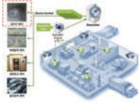
**기술내용** 국내 RFID/USN 분야의 하드웨어 중 Cold Chain에 필요로 하는 센서 태그와 이를 인식할 수 있는 리더는 외산 제품이 대부분을 차지하여 이에 대한 국산 기술개발을 필요로 함. 이러한 가운데 온도와 습도 등 환경 인자에 민감한 식자재, 의약품, 혈청·혈액의 유통환경과 제조환경에 민감한 반도체·전자기기 공정에도 적용할 수 있도록 온도·습도와 같은 환경정보를 습득·처리하는 기술을 개발함. 핵심 기술은 생산에서 소비에 이르기까지 연속되는 일련의 저장 및 배송 과정에서 신선 제품의 지능적 온도제어 기술을 통한 제품의 품질 추적 기술임
