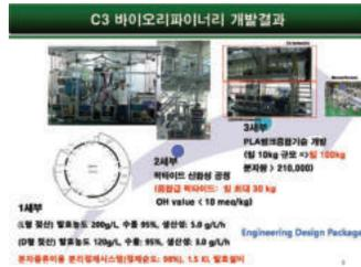
**기술내용** PLA는 대표적인 친환경 바이오플라스틱으로 휴대폰 케이스 및 자동차용 플라스틱 소재로서 전 세계적으로 수요가 증가하고 있음. 국내 산업계에서도 PLA 수요가 급증하나 국산화 이전까지 선진 독점기업의 배급에 의존해야 하는 상황으로 국산화된 제조 기술이 필요함. 이러한 가운데 이 연구과제를 통해 광학순수형 중합급 젯산 발효, 정제기술을 비롯하여 연속식 젯산 예비중합 및 해중합에 의한 락타이드 제조 기술을 개발함. 이외에도 연속식 락타이드 증류에 의한 PLA 중합급 락타이드 정제 기술, 고분자량의 PLA 중합 및 단량체 제거 기술을 확보함
