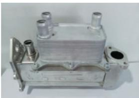
**기술내용** 이 기술은 A/T(ATF: Automatic Transmission Fluid) 오일의 냉각을 위해 공랭식과 라디에이터 내장형 수냉식 오일 쿨러 두 개를 직렬 연결하던 기존 시스템을 하나의 외장형 수냉식 오일 쿨러를 EGR (Exhaust Gas Recirculation, 배기가스 재순환장치) 쿨러와 일체형으로 하는 모듈화 기술임. 기존 시스템에서는 주위 온도가 낮은 겨울철에는 공랭식일 경우 A/T 오일의 워업이 상당히 지연되고, 수냉식 또한 초기 냉간 시동 시에는 라디에이터로의 냉각수 순환이 차단되기 때문에 워업이 상당히 늦음. 연구개발에서 개발한 기술을
