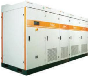
**기술내용** 대용량 태양광발전시스템에 사용되는 태양광 인버터의 전력 변환 효율 향상을 위해 발전량에 따라 동작하는 모듈 인버터 수를 EMS를 통해 제어하여 최고의 전력 변환 효율을 얻도록 하고, 모듈 인버터의 표준화와 규격화로 대량생산하여 원가를 절감하는 기술이며, 이러한 효율 향상 및 원가절감을 위해 모듈형 인버터에 적합한 MPPT 기술, 모듈형 인버터에 적합한 계통 연계 및 단독 운전 검출 기술, 모듈 인버터의 방열 설계를 포함하는 스택(Stack) 설계 및 양산기술 및 전력회로 설계 및 운전기술을 개발했고, 동시에 모듈 인버터의 동작시간을 카운트하여 사용되는 모듈 인버터의 동작시간이 평균화되도록 함으로써 모듈형 태양광 인버터의 수명 증가 기술을 적용하여 250kW, 500kW, 750kW 및 1000kW 용량대로 제품화를 완료함
