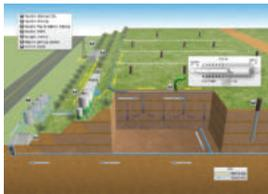
**기술내용** 바이오리액터형 매립공법이란 독성이 없는 침출수, 오폐수 등을 매립지 내로 재순환하여 매립가스 증산 및 조기 안정화 구현이 가능한 신개념 매립공법임. 폐기물 매립지의 위생 관리를 위한 중간 복토 및 최종 복토 규정이 강화되면서 유기성 폐기물의 분해가 장기화되면서 매립가스 발생량 감소 및 안정화 기간이 장기화되는 현상이 발생함. 이로 인한 매립가스 자원화의 경제성 확보 어려움, 안정화 기간 장기화에 따른
