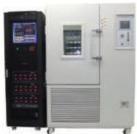
**기술내용** 스크리닝 장치는 주로 소자 제작 시 발생하는 문제를 찾아내기 위한 것으로 출하검사의 필수 항목으로, LED 칩 및 패키지 제조사에서는 일반적으로 가속 테스트를 실시하는데 초기 값을 수동으로 측정 후 가속 조건에서 소자를 구동하면서 주기적으로 구동을 중지하고 전기 광학적 특성을 측정하여 특성의 변화량을 모니터링하여 생산품의 출하 여부를 결정함. 국내의 경우 각 제조사가 독자적으로 구성한 장치를 사용하여 문제 발생 시 스크리닝 검사 방법에 논쟁 여지가 많았으며 또 수동 측정으로 인해 측정 과정에서 소자에 물리적 충격을 발생시키기도 함. 당사에서 개발한 스크리닝
