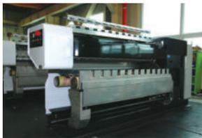
**기술내용** 합성섬유 원사제조설비는 폴리에스터, 나일론 등의 인조섬유 원사를 생산하는 설비로서 방사기, Take-up, 고속와인더 등 각 공정별 설비로 이루어짐. 합성섬유 원사 제조공정 가운데 POY는 물론 FDY 공정으로 원사를 생산하는 설비를 양산하기 위해 안정적 운전을 위한 저진동 고속회전체 제작기술, 정밀 회전속도 제어기술, 트레버스 제어기술, 공압 메커니즘과 그에 따른 시퀀스제어기술 등을 개발하여 최대 사속 6,000m/min급 Hot Goddet Roller System과 고속와인더를 포함한 합성섬유 원사제조설비를 개발함
