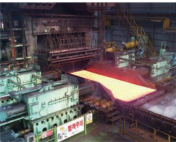
**기술내용** 전량 수입되던 광폭후판압연용 주조재 워크롤 및 형강압연용 고탄소 단조롤 국산화 개발에 성공. 초대형 규격의 후판용 주조재 워크롤 제조 원천 기술 확보. 90톤 수평원심주조기 자체 설계 및 제작, 이종재질 접합 및 열처리 등 제품화 기술, 내마모성 향상을 위한 신강종 합금설계 기술을 확보. 형강용 고탄소 단조롤(1.3% 탄소 이상) 제조 원천 기술 확보. 고탄소 INGOT 제조기술(지향성 응고제어기술), 단조 기술(크랙제어 단조), 성능제어 열처리 기술 확보
