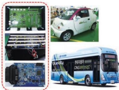
**기술내용** 향후 세계 자동차 시장에서 지속적인 성장과 경쟁력 확보를 위해서는 하이브리드 자동차(HEV; Hybrid Electric Vehicle)와 전기자동차(EV; Electric Vehicle) 등 친환경 자동차의 개발이 필수적임. 이에 적용할 수 있는 대형전지와 BMS의 개발은 경제·산업적 측면에서 반드시 확보되어야 할 매우 중요한 기술임. 이에 따라 2차전지의 전압·전류·온도를 측정하는 기술과 잔량을 실시간으로 연산하는 SOC, 상태를 예측하는 SOH, 전압의 편차를 줄이는 Cell Balancing 기술 등 소형 2차전지 분야의 BMS 세계시장점유율 1위권에 도달한 기술을 확보함
