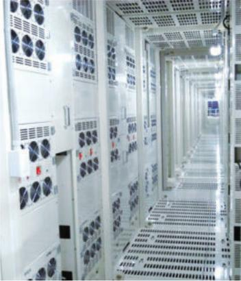
**기술내용** 개발된 에너지 저장장치용 고효율 충·방전 시스템은 친환경 자동차 산업뿐만 아니라 최근 로봇 산업이나 IT 산업, 전력계통 분야에서 요구하고 있는 대용량 에너지 저장 시스템 구축에 수반되는 2차 전지 및 울트라 커패시터 등의 양산 제조에 필수적인 장비임. 개발된 고효율 충·방전 시스템은 향후 다양한 산업에 활용이 가능한 국가 에너지 유관산업의 발전에 기여할 것으로 기대되는 기술임. 핵심 기술은 2차 전지, 차량시스템 및 전기전자 제어, 전력 변환에 관한 기술과 노하우를 바탕으로 에너지 회수가 가능한 스위칭 방식의 고효율 충전 시스템임
