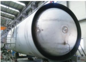
**기술내용** 선박용 LNG 연료 공급 시스템은 선박 엔진의 동력원인 LNG를 저장하기 위한 선박용 LNG 연료탱크, 액체가스 상태의 LNG를 선박 엔진 공급에 적합한 기체 상태의 천연가스로 전환하기 위한 기화기(Vaporizer), 탱크-기화기-선박엔진 사이의 공급 배관을 포함하는 Cold Box, 공급 시스템 자동 운전을 위한 컨트롤 시스템, 연료 탱크 충전을 위한 Bunkering 시스템 등으로 구성됨. '선박용 청정 연료 LNG 탱크 및 기화기 개발' 연구과제는 해양 환경 규제 강화 추세에 따라 선박 내 추진 및 발전용 엔진의 배기가스를 줄이기 위한 방안으로 대두되고 있는 선박용 액화천연가스(Liquefied Natural Gas, 이하 LNG) 연료 공급
