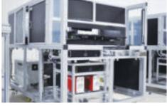
**기술내용** 액정표시장치(LCD) 및 유기발광다이오드(OLED) 산업에서 사용되는 유리 기판은 생산 과정에서 굴곡 불량이 발생할 수 있는데, 이러한 굴곡 불량은 나중에 디스플레이 패널이 만들어졌을 때 심각한 품질 불량의 원인이 될 수 있음. 그동안 이런 굴곡 불량을 잡기 위해서는 기판을 파괴해 만들어진 샘플을 이용, 표면을 탐침으로 스캔하는 수작업으로만 검사해야 했음. 하지만 비접촉·광학식 굴곡(waviness) 검사 기술은 유리 기판상의 불량을 광학적 방법으로 기판의 파괴 없이 실시간으로 전수 검사함으로써 유리 기판의 굴곡 불량을 검사하는 세계 최초의 기술임
