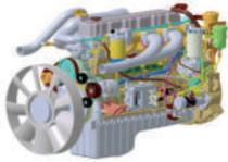
**기술내용** 디젤엔진의 효율을 최대화하면서 입자상물질(PM)과 질소산화물(NOx)을 동시에 저감하는 방법 중 하나인 고효율 연소 기술과 요소 첨가 선택적 반응 시스템(Urea-SCR)을 적용하는 상용차용 디젤엔진을 개발함. 한국에서는 처음으로 Urea-SCR를 상용차에 적용한 기술임. Urea-SCR는 배기 후처리 촉매 장치로, 배기관 내에 요소수(Urea Solution)를 분사하면 배기열에 의해 암모니아가 생성되며 이 암모니아가 배기가스 중의 NOx와 반응해 무해한 물과 질소로 분해, 깨끗한 배기가스를 대기 중에 배출하는 장치임
