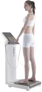
**기술내용** 동시 다주파수 임피던스 측정(SMFIM: Simultaneous Multi-frequency Impedance Measurement) 기술은 동시에 다수의 주파수를 인체에 인가해 각각의 주파수 성분에 해당하는 임피던스 값만을 얻어내는 기술임. 체성분 분석기 최초 SMFIM 기술 개발과 관련해 타사를 포함한 기존 체성분 분석기의 문제점은 측정 주파수를 시간대별로 순차적으로 보냄으로써 세포 내외 수분 측정값의 정확도가 떨어지고 2~3분 정도의 측정 시간이 필요하며 측정 중 측정자가 외부 전기적 노이즈에 노출될 경우 정확한 값을 얻기 위해 재측정해야 하는 기술적인 한계가 있음. 이를 SMFIM 기술을 적용해 측정 시간은 5분의 1까지 단축, 정밀도 향상과 함께 측정의 편리성을 얻고 측정 중 자세 변화로 발생하는 오차와 다양한 전자 기기로부터 외부 노이즈에 따른 오차 등 기존의 한계를 극복함
