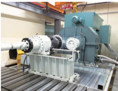
**기술내용** 저탄소 녹색 선박을 위한 전기 추진 선박의 핵심 기술인 지능형 전력 기자재는 전기 추진 선박의 핵심 기술로, 지능화되는 선박의 전력 환경 변화에 대응하기 위해서는 해외 의존도가 높은 지능형 전력 기자재에 대한 엔지니어링과 시험평가, 인증 등 R&D 지원체계 개발이 필요함. 이에 HILS(Hardware-in-the-Loop Simulation) 기반 선박 환경 모사를 통한 지능형 전력 기자재의 시험 기술 및 3MW급 AC 다이내모 시험 평가 기법을 개발함. 더불어 지능형 전력 기자재 인증지원체계를 개발하고 엔지니어링 국제 연계 협력을 구축함. 본 연구 과제의 핵심 기술은 녹색 선박 전력 기자재의 시험·인증 기술, 지능형 전력 기자재 시험 평가·인증 지원 체계임
