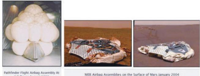
〈그림 8〉 Vectran®을 사용한 NASA 화성탐사선 Pathfinder의 착륙 에어백 출처: <http://www.ilcdover.com/Mars-Pathfinder-Exploration-Rover-MER/>
