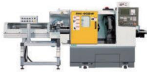
**기술내용** 그동안 웜 기어 샤프트(worm gear shaft)는 전조라는 소성 가공 방법으로 생산돼 정밀도 저하, 생산성 저하라는 문제점이 발생함. 이번에 개발된 초정밀 고품질 웜 기어 샤프트 절삭 가공용 스레드 휘링 머신(Thread whirling machine)은 휘링 유닛(whirling unit)에 커터(cutter)를 장착, 고속으로 회전시켜 한 번 이송으로 웜 기어 샤프트를 가공하는 기술을 적용, 정밀도와 생산성을 향상시킴. 이 장비의 국산화로 수입 대체 효과 및 국내 자동차 성능이 높아지고 기술이 축적돼 관련 산업으로의 기술 확대가 가능해질 것으로 예상됨
