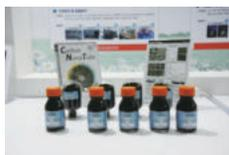
**기술내용** CNT는 우수한 기계적 · 전기적 · 열적 특성으로 꿈의 소재로 불림. 하지만 CNT 분말은 수많은 튜브들이 엉켜 있는 응집체로 존재해 나노 소재로 활용하기가 어려운데, 이를 해결할 수 있는 CNT 분산 공정 기술을 개발함. 이 기술은 다양한 분산 공정 및 설비를 통한 복합적인 기계적 분산 메커니즘을 이용해 실타래처럼 엉켜 있는 CNT를 용제 내에서 각각의 튜브로 분리(isolation)하고 이 상태를 장기적으로 유지할 수 있는 공정 기술임
