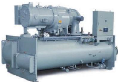
**기술내용** 냉각수 저온 제어형 2단 터보 냉동기는 대체 냉매인 HFC-134a를 적용해 압축기의 구성품과 전동기 효율이 94.5%인 고효율 모터를 개발, 압축기에 조립한 후 KS B 8208에서 규정하는 시험 절차에 따라 시험을 수행해 시스템 효율이 0.55kW/RT를 초과하는 냉동기임. 산업용 냉동기의 특성상 냉각수 저온 공급에 따른 안정적인 운영이 가능한 시스템, 섭씨 영상 12도의 저온 냉각수 온도에서도 운전 신뢰성이 높고 86dB 이하의 저소음 운전이 가능하며 서지 마진(surge margin)을 3도 이상으로 확보함으로써 하절기 냉각수 온도 고온에 따른 서징(surging)과 같은 문제점을 예방할 수 있는 신뢰성을 지닌 터보 냉동기를 개발함
