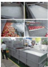
**기술내용** 농산물 재배 농가에서의 농약 과다 사용으로 인한 농산물 잔류 농약에 의한 사회적 문제가 대두됨. 농산물 잔류 농약에 의해 안전한 먹거리 미확보와 이로 인한 환경 호르몬 등의 발생 원인으로 작용함. 본 연구 과제에서는 마이크로 버블을 이용하여 이와 같은 문제를 해결하며 농산물의 안전성을 확보함. 더불어 마이크로 버블을 이용한 농산물 세척으로 농산물의 부가가치를 향상시켜 농가 소득 향상이 기대됨. 또한 마이크로 버블 발생기를 이용하여 기타 산업 응용이 용이하여 향후 수처리 산업분야, 해양 미세조류 수거로 에너지 산업, 양식 산업 등으로 진출이 가능함. 핵심 기술은 마이크로 버블을 이용한 농산물 잔류 농약 제거 시스템임
