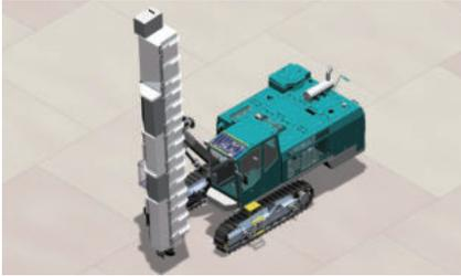
**기술내용** 고효율 지능형 천공 장비의 필수 요소인 대유량 Load Sensing 및 전자비례 유압제어 시스템, Drifter 및 Feed용 고효율 유압모터, 20kW급 고성능 Drifter, 고정도 위치제어 ARC, 고장력 경량 내마모 Al. Mast, 저소음 차폐모듈, 천공 모니터링 통합제어 기술, 내마모 내충격 천공공구 기술을 개발하여 선진 천공장비와 대등한 수준의 핵심 기술을 확보
