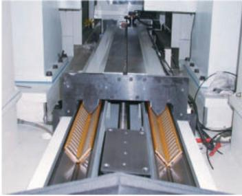
**기술내용** 니들 롤러를 이용한 고하중용 플랫 케이지(flat cage) 직선운동 베어링은 정밀 연삭기, 고속 프레스기 등의 베드와 주축 등의 구동 이송부에 장착되는 직선운동 베어링임. 대형 공작기계의 이송부를 높은 강성과 낮은 마찰저항(0.002이내)으로 5 $\mu$ m/500mm 이내의 정밀한 이송이 가능하게 하는 기술이 적용됨. 한 쌍의 레일 두 개와 다수의 니들 롤러, 니들 롤러의 정렬 및 일정한 간격을 유지하기 위한 케이지로 구성됨. 레일을 제작하기 위해 고탄소강의 소재를 최적의 내구 수명과 고정밀도를 갖도록 하는 열처리 기술과 연삭 기술, 초정밀·고강성의 니들 롤러를 제작하기 위한 고정밀 원통 연삭 기술, 케이지를 제작하기 위한 금형 기술 등 모든 과정을 국내 기술로 개발함
