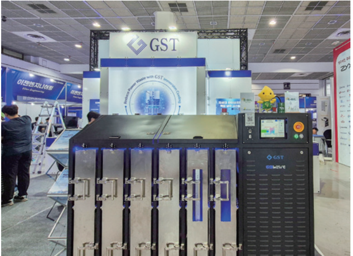
S-OIL과 GST가 선보인 데이터센터용 액침 냉각 시스템. 서버를 비전도성 절연 액체에 직접 담가 열을 식히는 장치. S-OIL의 액침 냉각유 ‘S-OIL e-쿨링 솔루션’과 GST의 액침 냉각 장비를 결합해 고성능 AI 서버의 발열을 효율적으로 제어한다.
