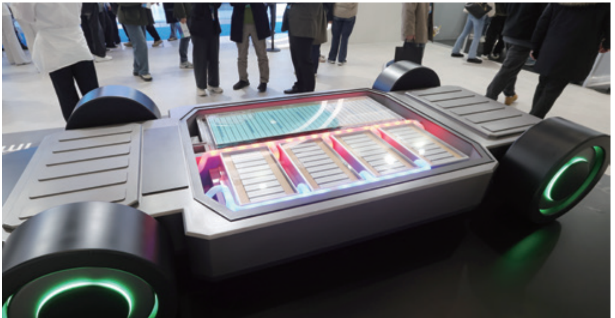
SK온의 전기차용 액침 냉각 배터리 모형. 전기차 배터리팩 내부에 전기가 통하지 않는 특수 절연유(비전도성 유체)를 직접 채워 냉각하는 방식. 열 폭주를 방지하고 충전 및 냉각 효율을 극대화하는 차세대 액침 냉각기술을 보여준다.
